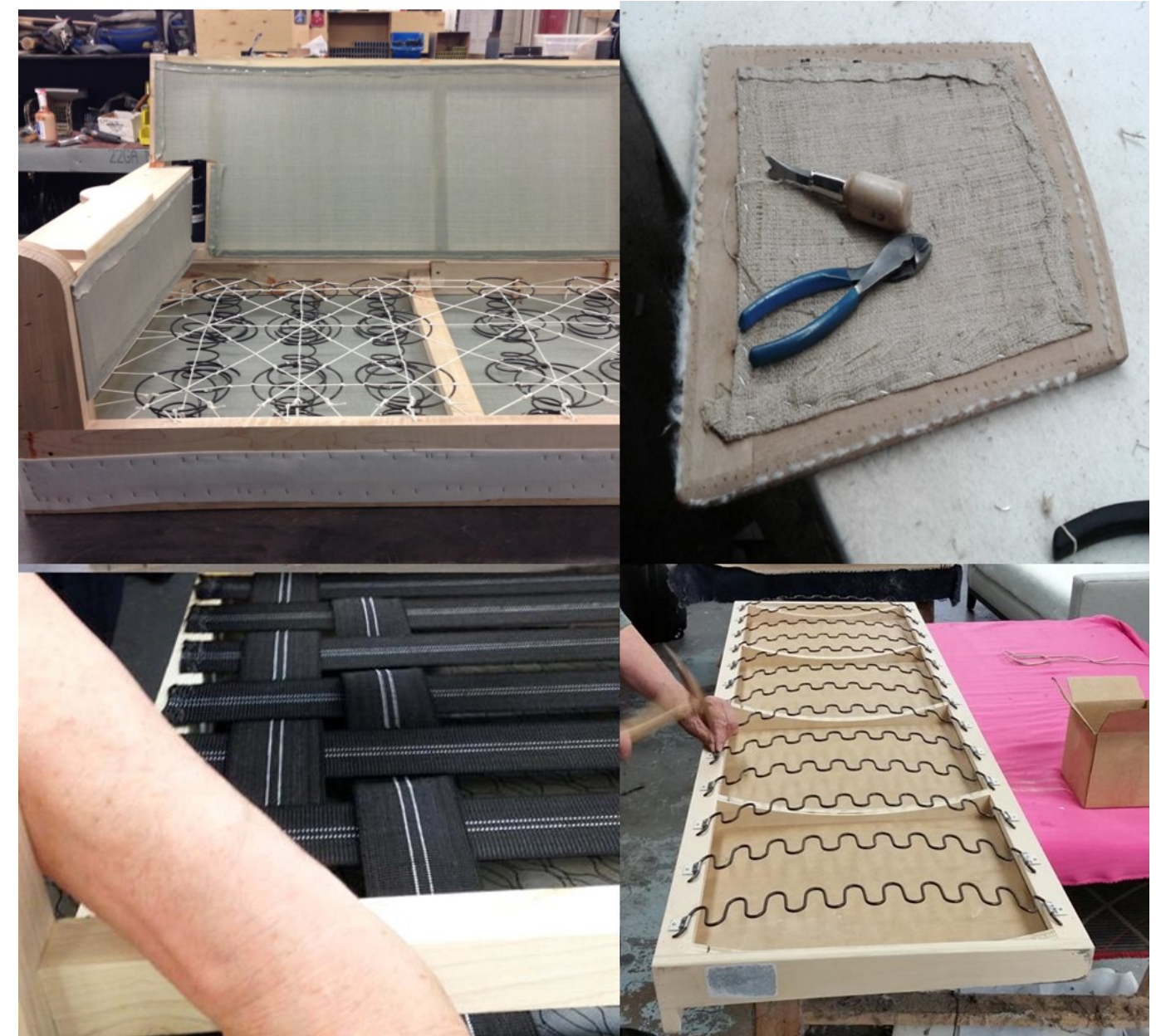
La costruzione del telaio degli imbottiti con l'integrazione tra poliuretano sagomato, legno e parti in metallo
